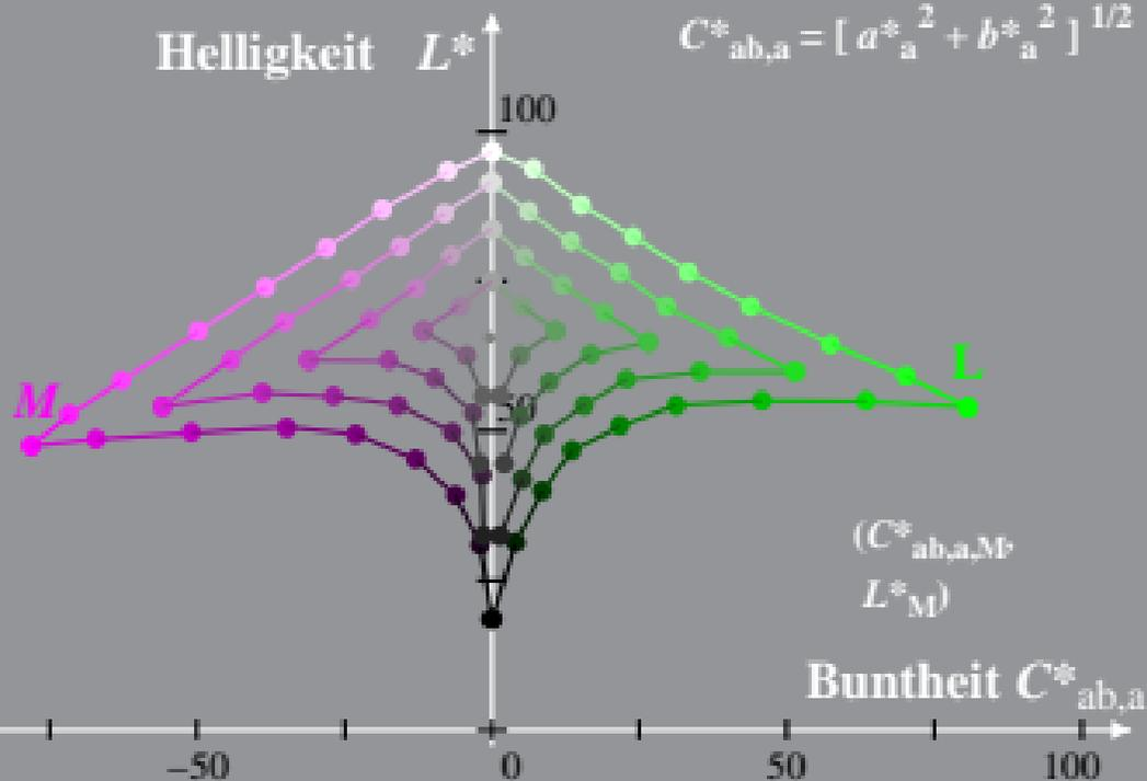
Beziehung CIELAB ( $L^*$ ,  $a^*$ ,  $b^*$ ) und adaptiertes (a) CIELAB ( $C^*_{ab,a}$ ,  $L^*$ )
