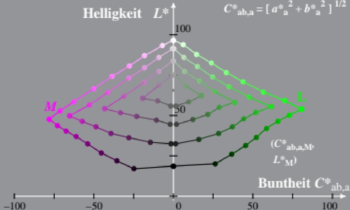
Beziehung CIELAB ( $L^*$ ,  $a^*$ ,  $b^*$ ) und *adaptiertes* (a) CIELAB ( $C^*_{ab,a}$ ,  $L^*$ )
