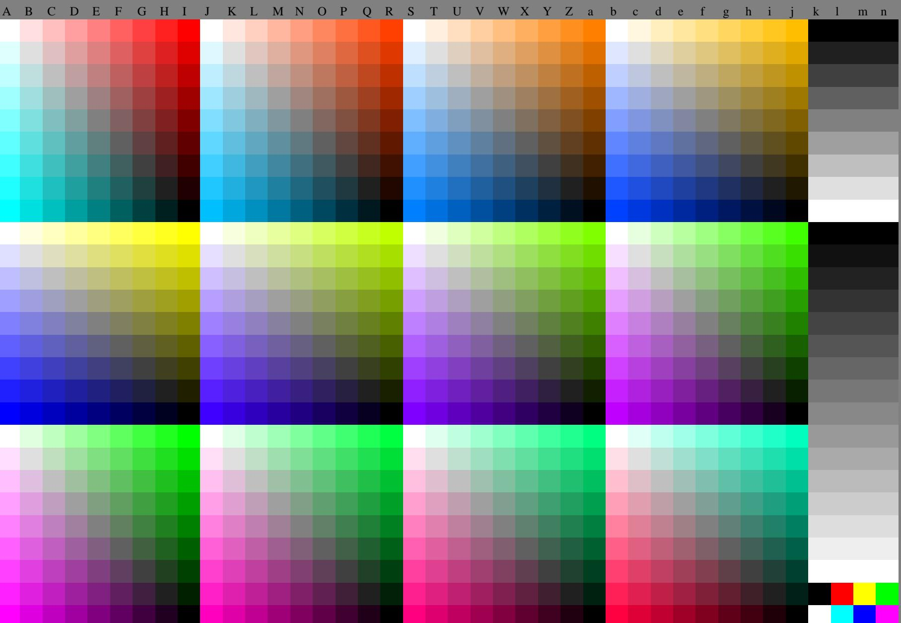
AS59-70 Graphico de prueba AS59 con 1080 colores; escalas de colores de 9 o 16 pasos; los datos en la columna (A-n): rgb + cmy0 (A-j + k26-n27), 000n (k), w (l), nnn0 (m), www (n)
