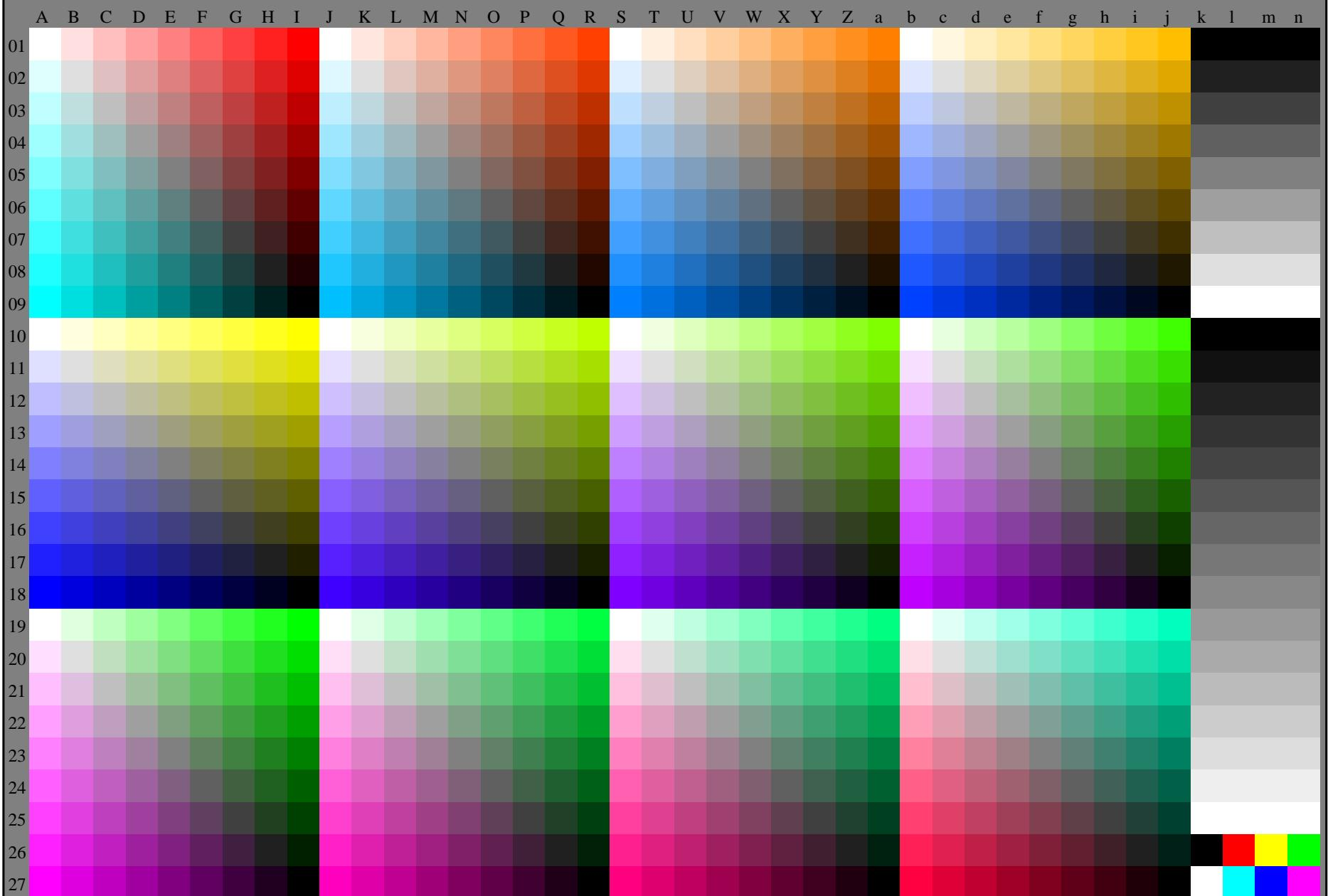
AS56-70 Graphico de prueba AS56 con 1080 colores; escalas de colores de 9 o 16 pasos; los datos en la columna (A-n): **rgb + cmy0 (A-j + k26-n27), 000n (k), w (l), nnn0 (m), www (n)**
