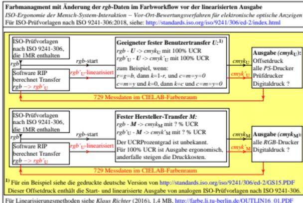
TUB-Registrierung: 20200601-AGY9/AGY9L0N1.TXT /PS Anwendung für Messung von Display- oder Druck-Ausgabe
