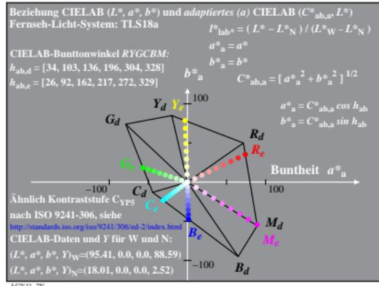
TUB-Prüfvorlage AGY4; TLS00a, TLS06a, TLS11a, TLS18a und CIE-Elementarbunttondaten im CIELAB-Diagramm ( $a^*, b^*$ )
