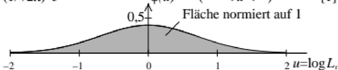
Verteilungsfunktion  $\Phi(u)$  **entspricht der CIE Helligkeit  $L^*$**
