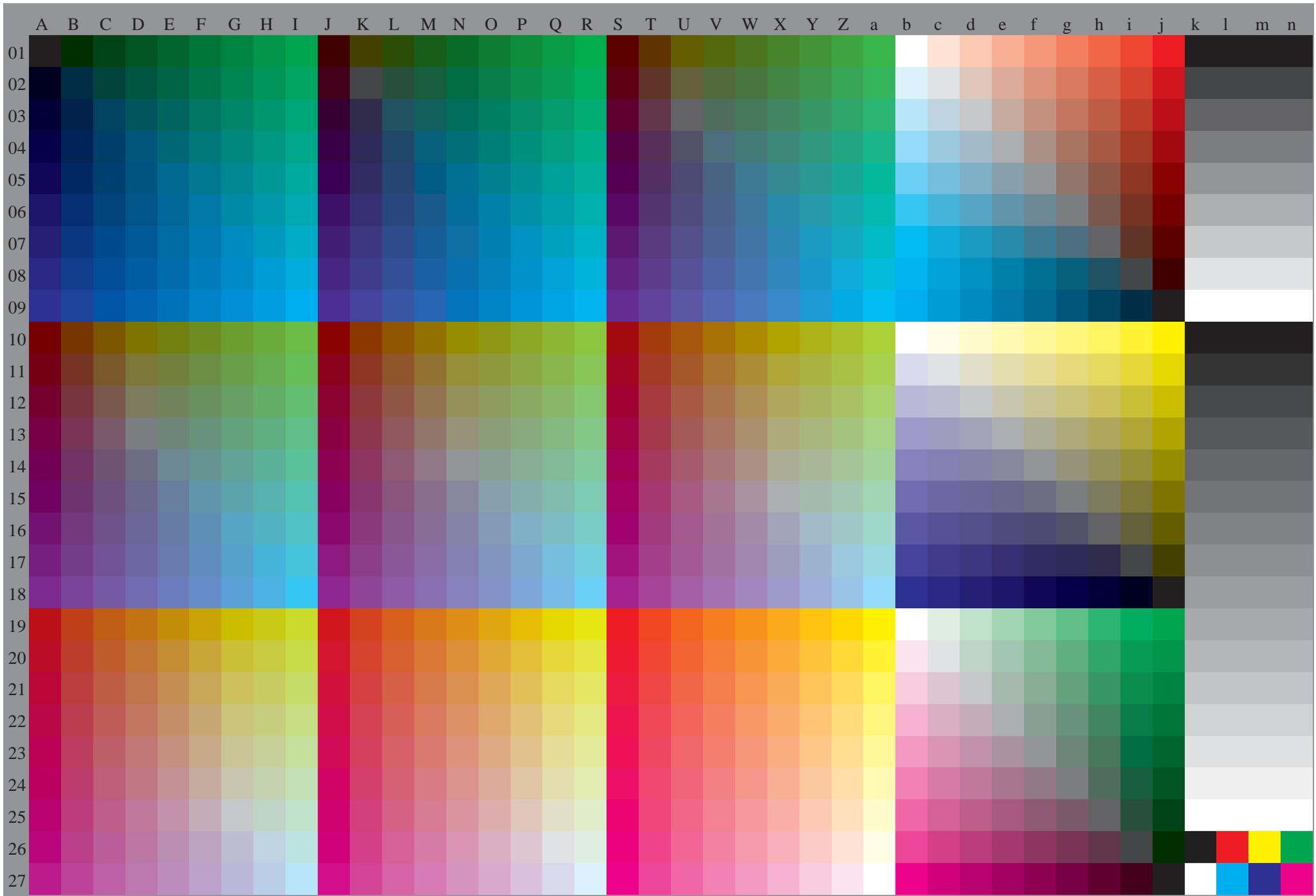
ZG480-7N, Prüfvorlage mit 40x27=1080 Farben; digital gleichabständige 9 oder 16stufige Farbreihen; Farbdaten in Spalte (A-n): rgb (A-j, n), 000n (k), w (l), nnn0 (m), 5,4mm x 5,4mm, Seite 6/6, ORS18
