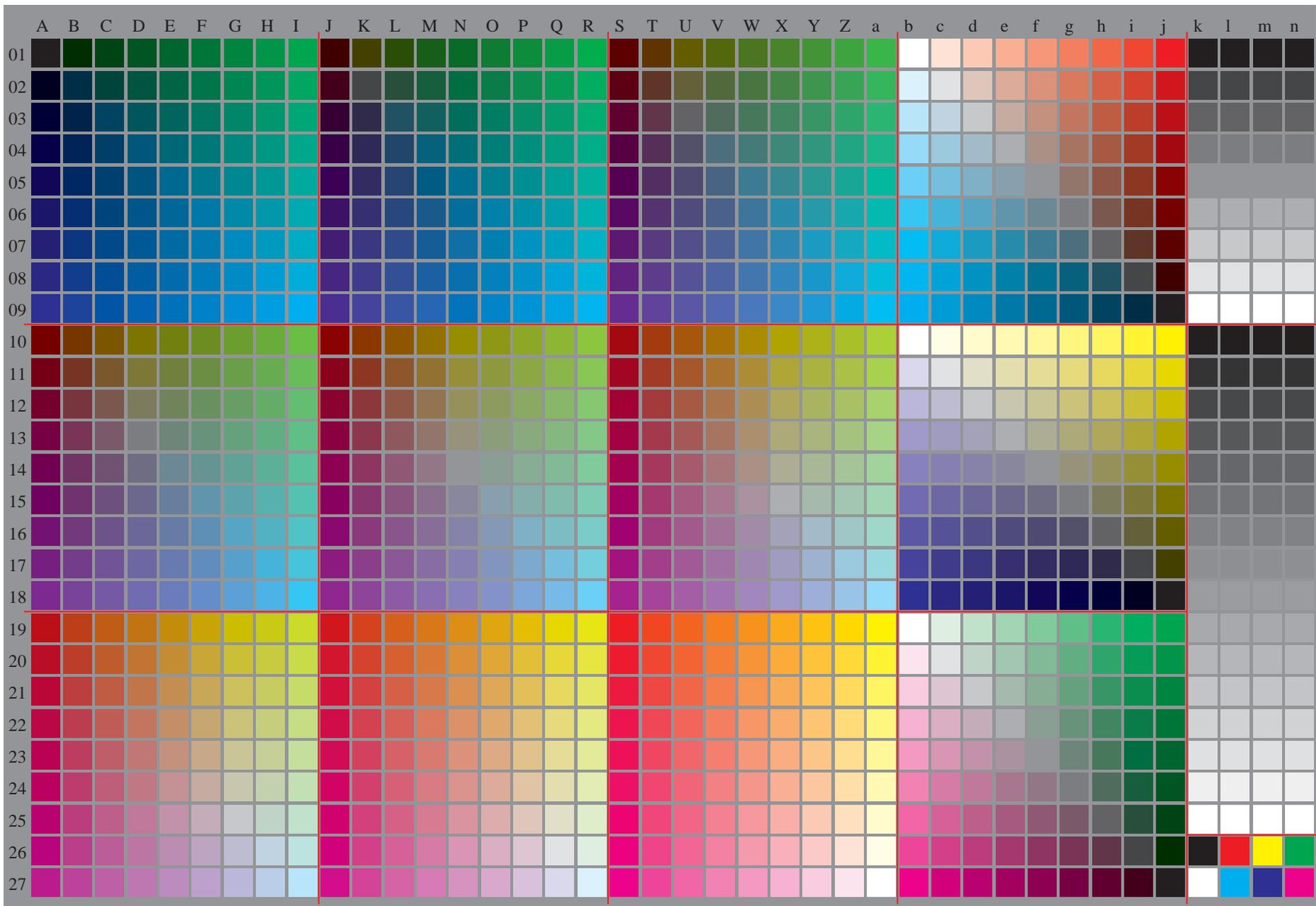
ZG480-7N, Prüfvorlage mit 40x27=1080 Farben; digital gleichabständige 9 oder 16stufige Farbreihen; Farbdaten in Spalte (A-n): rgb (A-j, n), 000n (k), w (l), nnn0 (m), 5,4mm x 5,4mm, Seite 3/6, ORS18
