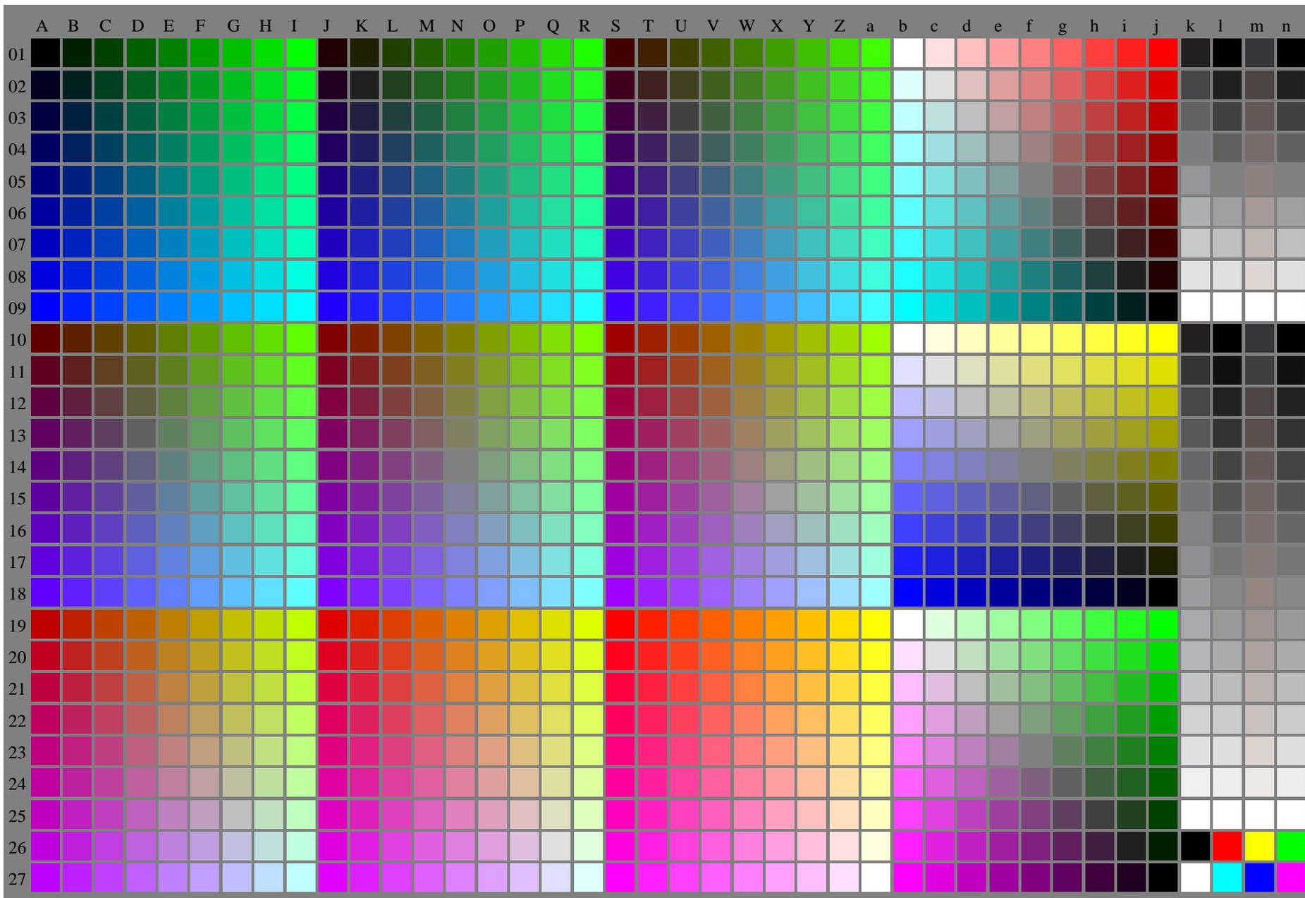
ZG480-7N, Prüfvorlage mit 40x27=1080 Farben; digital gleichabständige 9 oder 16stufige Farbreihen; Farbdaten in Spalte (A-n): rgb (A-j, n), 000n (k), w (l), nnn0 (m), 5,4mm x 5,4mm, Seite 1/6, ORS18
