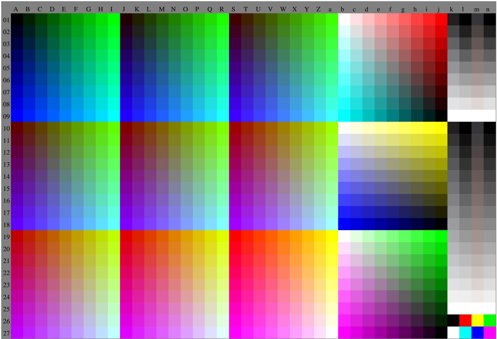
ZG480-7N, Prüfvorlage mit 40x27=1080 Farben; digital gleichabständige 9 oder 16stufige Farbreihen; Farbdaten in Spalte (A-n): rgb (A-j, n), 000n (k), w (l), nnn0 (m), 5,4mm x 5,4mm, Seite 5/6, ORS18
