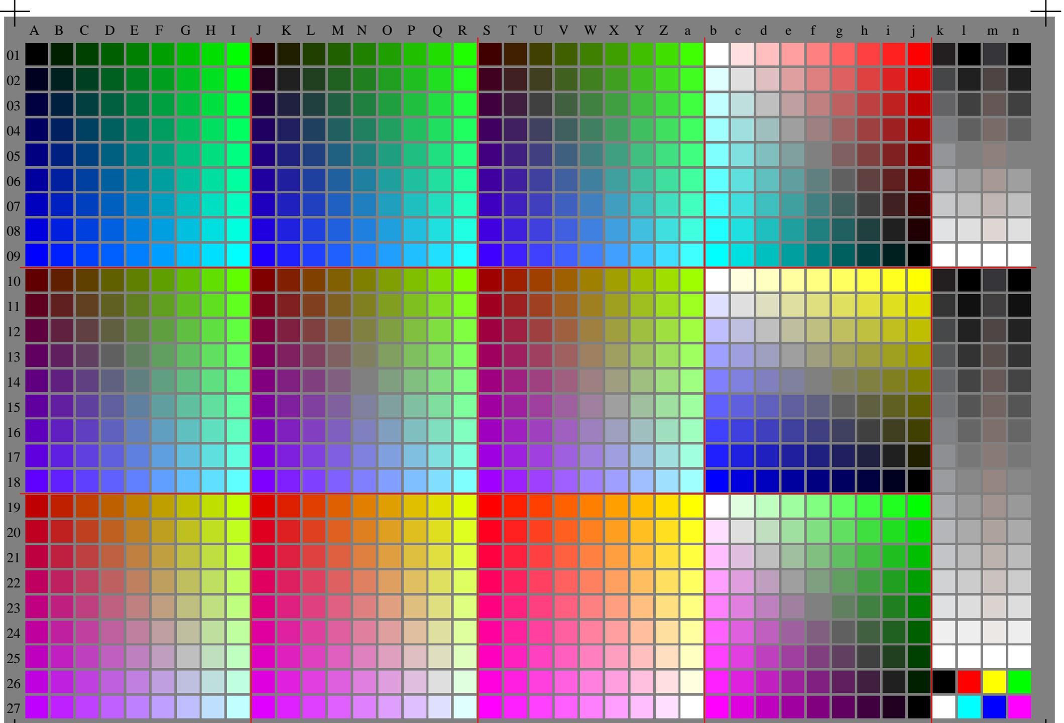
YG220-7N, Prüfvorlage mit 40x27=1080 Farben; digital gleichabständige 9stufige Farbreihen; vergleiche ISO/IEC 15775; rgb-Farbdaten, Mustergröße und graues Layout: 6,0mm x 6,0mm, 275mm x 187mm, Seite 2/3
