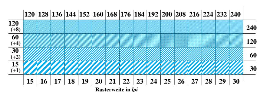
MG060-2, Bild C5: Linienraster unter 45° (oder 135°); Benutzung des PS-Operators `n000* setcmykcolor`
