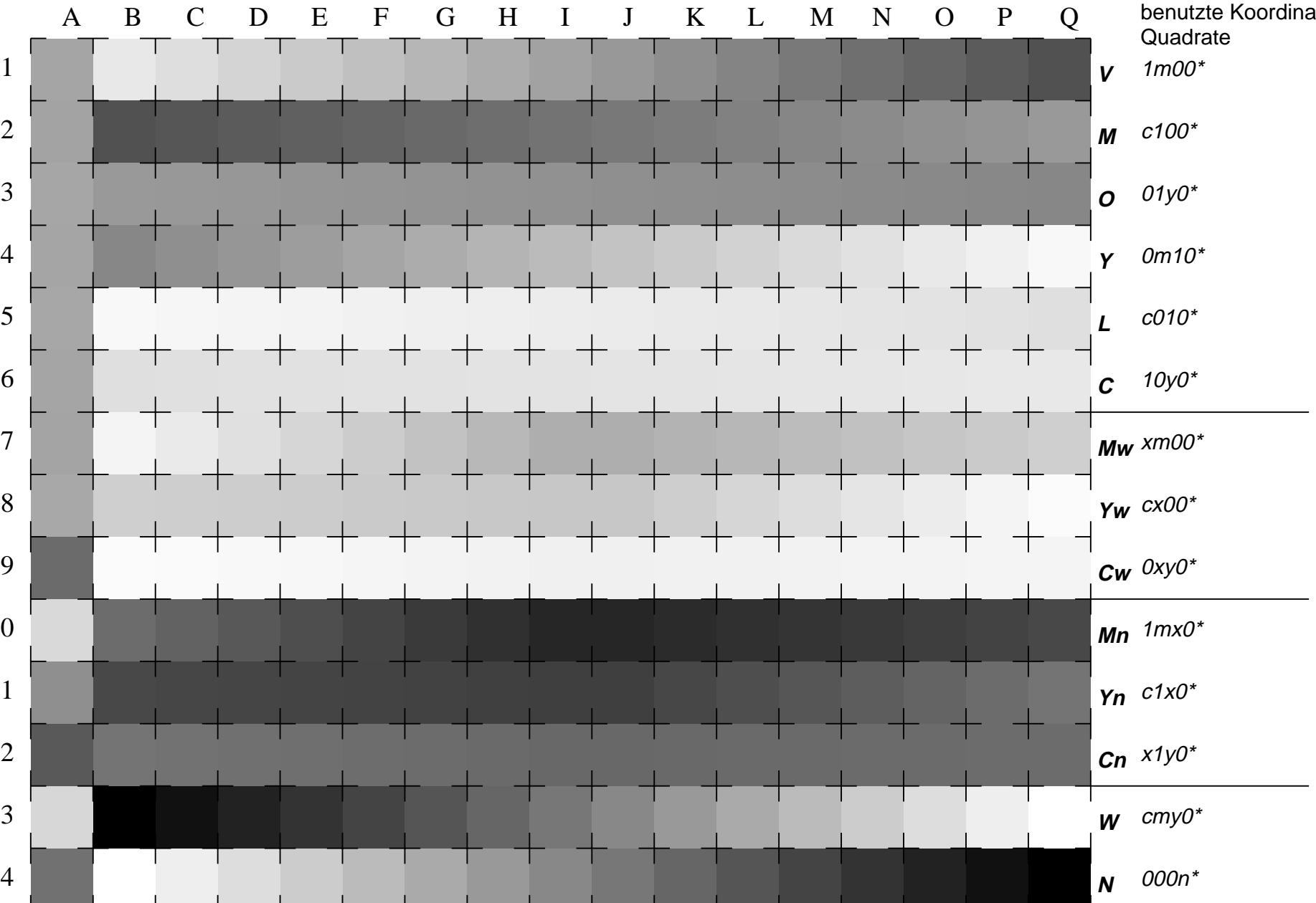
16 gleichabständige CIELAB-Stufen in  $cmy0^*(TLS00)$  für Farbserien C-V, V-M, M-O, O-Y, Y-L, L-C, N-W, W-N, Cw-Mw, Mw-Yw, Yw-Cw, Cn-Mn, Mn-Yn, Yn-Cn und 14 CIE-Testfarben (links)
