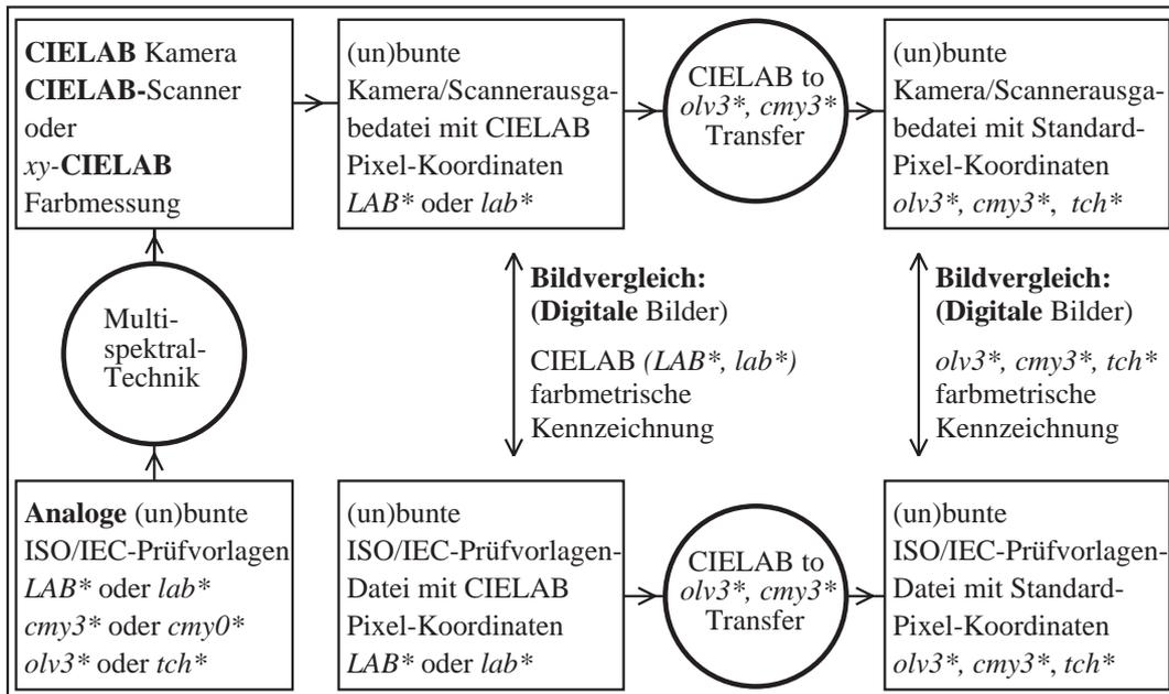
LG430-7, Transfer von geräteunabhängigen Daten *LAB\** nach geräteabhängigen Daten *olv3\**, *cmY3\** und *tch\**
