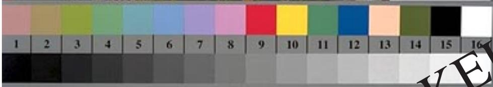
Bild D1: Blumenmotiv, 14 CIE-Prüffarben nach CIE-Publ. 13.3 sowie 2 + 16 Graustufen; Negativ
