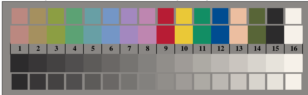
Bild B3: 14 CIE-Prüfbarben sowie 2 + 16 Graustufen; Benutzung des PS-operators LAB* setcolor
