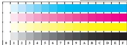
Bild B4: 16 gleichabständige Stufen W-C, W-M, W-Y und W-N; PS-Operator cmy0^*/000n^* setcmykcolor
