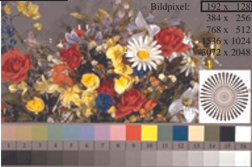
Bild B1: Blumenmotiv, 14 CIE-Prüffarben sowie 2 + 16 Graustufen (sf); PS-Operatoren settransfer , 4 colorimg
