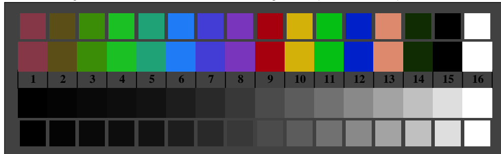
Bild B3: 14 CIE-Prüffarben sowie 2 + 16 Graustufen; PS-operator cmY0*/000n* setmykcolor
