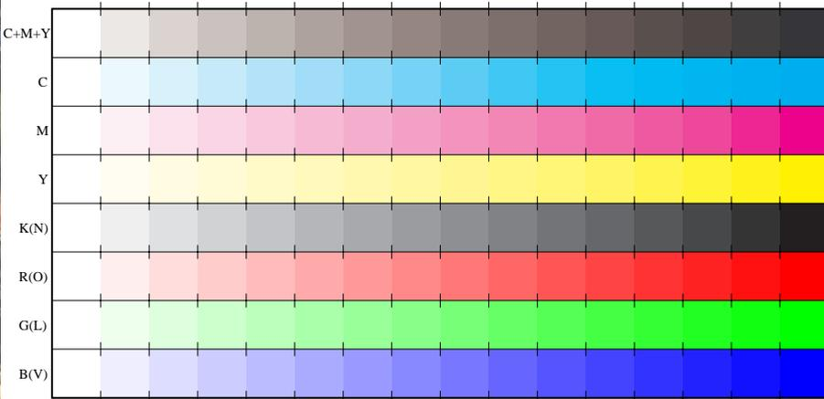
Bild 5: 16 gleichabständige Stufen für "Streifenbildung" und "Durchschlagen"
