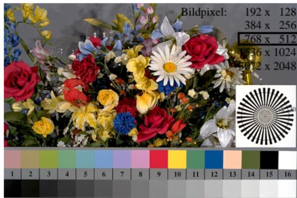
Bild D1: Blumenmotiv, 14 CIE-Prüffarben und 16 Graustufen (nf); PS-Operatoren *settransfer, 3 colorimage*
